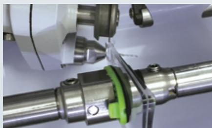
Grâce à cette même unité, la LEXCE Trend 8 réalise un rainage 3D, réglable en hauteur jusqu'à 0,8mm et largeur de 0,6 à 1,2mm. Le paramétrage des contre-biseaux jusqu'à 0,8mm face avant et arrière, confère au montage, une grande qualité de finitions.
