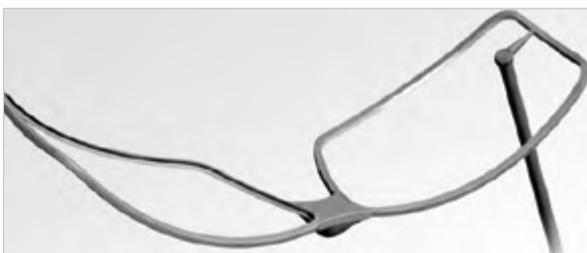
La conception unique de l'unité de traçage du LT-980 permet une inclinaison du stylet de palpation en fonction du galbe de la monture. Ainsi, la pointe du stylet reste toujours perpendiculaire à l'angle du drageoir.
