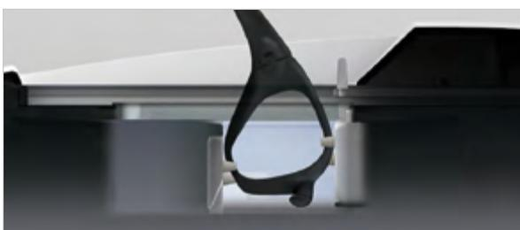
La mise en place de la monture est facilitée grâce aux clips de fixation inclinés. La pression de serrage est réduite au minimum afin d'éviter toute déformation de la monture.
