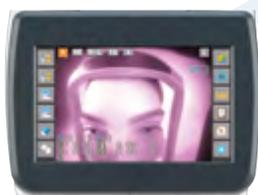
Dès que le visage est correctement positionné sur la mentonnière, une caméra grand-angle et des capteurs spécialement conçus par NIDEK détectent les yeux du patient et ajustent automatiquement la bonne position de la mentonnière. Le processus de mesure débute alors tout seul sans la moindre action sur l'écran de contrôle de la part de l'opérateur.
