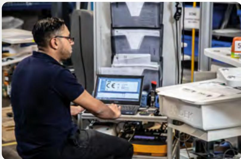
Dans un souci constant de sécurité et de qualité, toutes les unités sont testées tout au long de la production. Ainsi de nombreux contrôles sont effectués pendant et après la fabrication. Un contrôle final est réalisé juste avant l'emballage et l'expédition.
