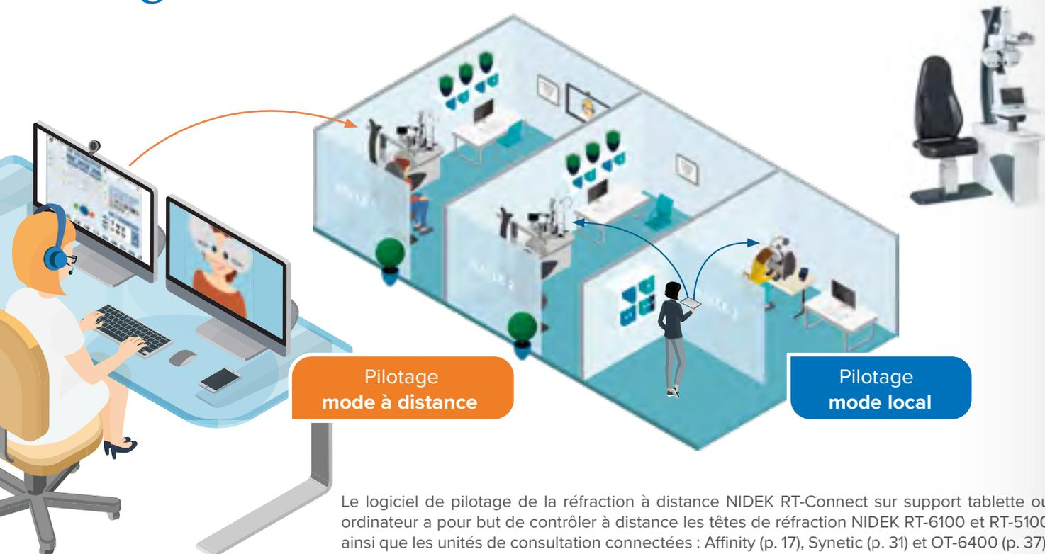
Le logiciel de pilotage de la réfraction à distance NIDEK RT-Connect sur support tablette ou ordinateur a pour but de contrôler à distance les têtes de réfraction NIDEK RT-6100 et RT-5100 ainsi que les unités de consultation connectées : Affinity (p. 17), Syntec (p. 31) et OT-6400 (p. 37).
