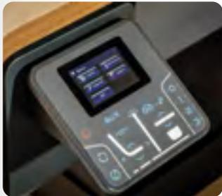
Le pupitre hybride est composé de bouton physique et d'un écran tactile. Il permet l'accès au bouton principaux, comme la montée/ descente du plateau ou du fauteuil ou la sortie des instruments en aveugle. Les fonctions secondaires, tel que l'inclinaison du bras de réfracteur, les auxiliaires programmables, les paramètres et la personnalisation, sont gérées sur l'écran tactile.
