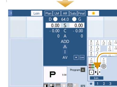
3-2 Sélectionner l'icône du test désiré. Le test est ajouté à la position du curseur.
