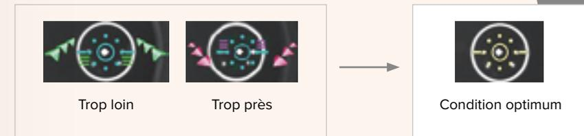
Quand l'alignement et la focalisation sont optimaux, les mesures sont prises automatiquement. Un indicateur d'alignement est affiché pour faciliter la prise de mesure.
