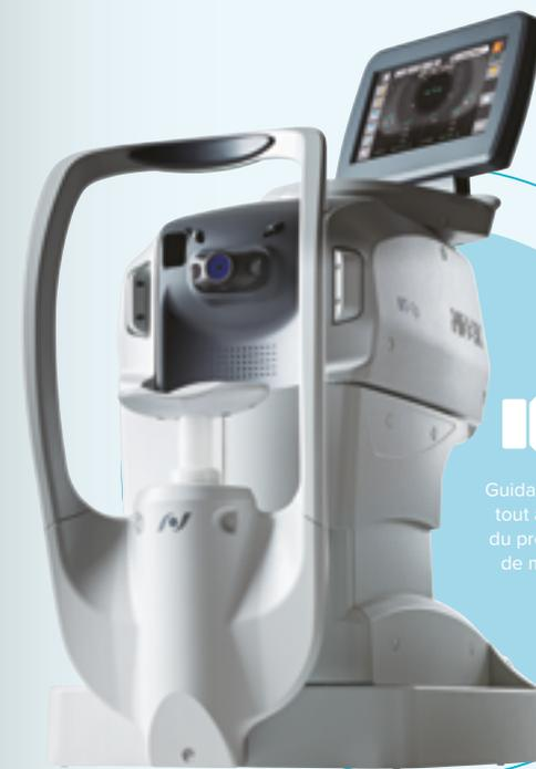
1 Détection automatique de la position des yeux (et réglage automatique de la position de la mentonnière si nécessaire).
